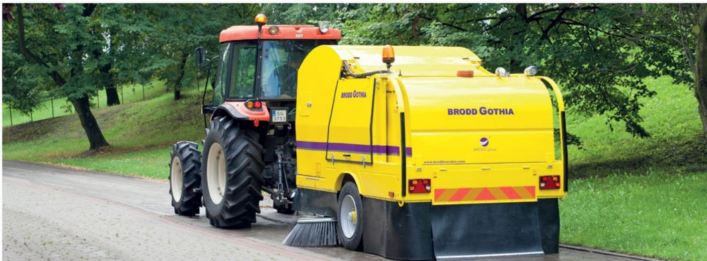
Инновационная высокопроизводительная подметальная машина BRODD GOTNIA с подъёмником!
