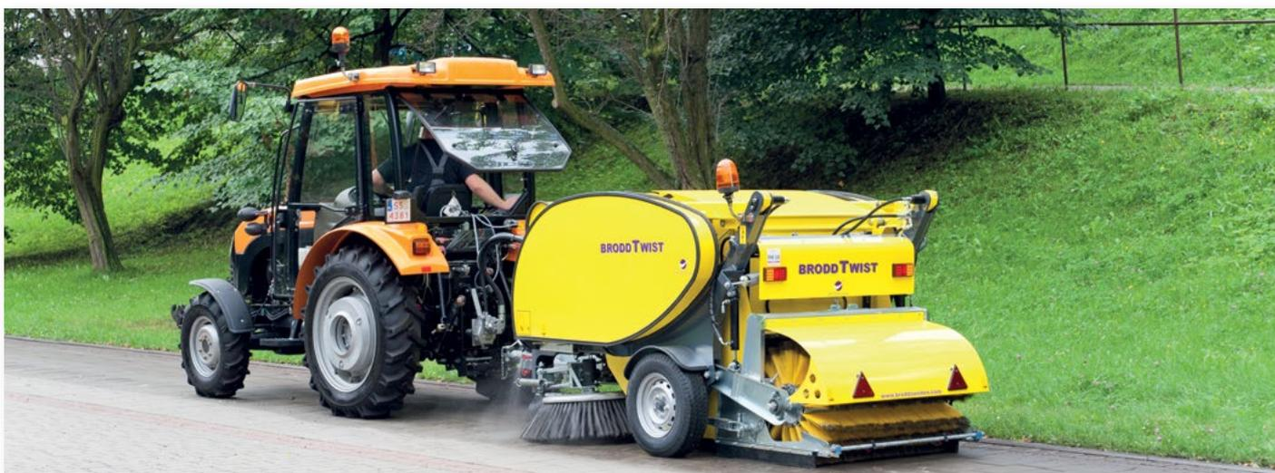
Механическая подметально-уборочная машина BRODD TWIST универсальная и эффективная подметальная система навесного типа для работы с мини тракторами и другими тягачами. Данные машины предназначены для уборки территорий с плотной застройкой и агрегируются с большинством типов мелкогабаритных тракторов, представленных на рынке.
