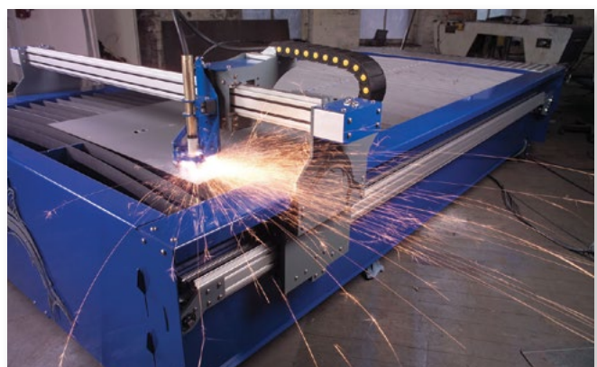
Установка плазменной резки
