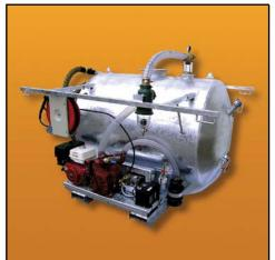
Вакуумные установки предназначены для сервисного обслуживания туалетных кабин, сбора и транспортировки жидких отходов, а также для очистки водой под высоким давлением и обслуживания заглубленных мусорных контейнеров. Устройство представляет собой емкость, выполненную из оцинкованной стали, разделенную на несколько отсеков и оборудованную вакуумным насосом и насосом ВД с приводом от автономного двигателя.
