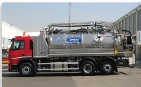
Каналопромывочные машины - рециклеры
