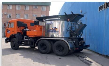
Машины для ремонта а/дорог литым асфальтом
