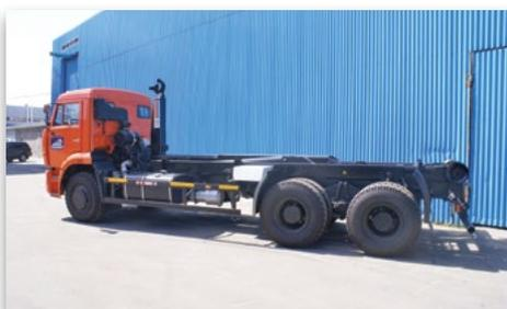
Автомобили с крюковым захватом
