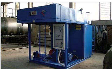
Автоматическая установка для производства битумных эмульсий
