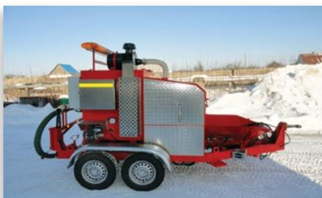
Прицепные установки для ремонта а/дорог методом пневмонабрызга
