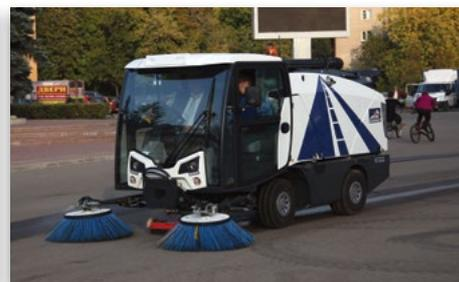
Машины вакуумные подметальные уборочные компактные
