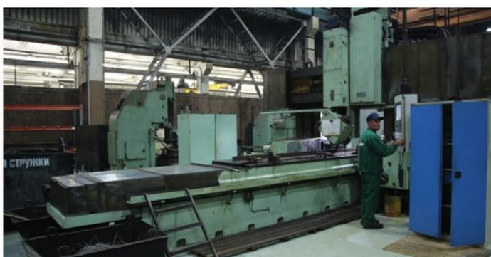
Продольный фрезерно – расточный станок
