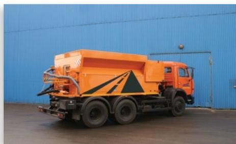
Машины для ямочного ремонта а/дорог методом пневмонабрызга
