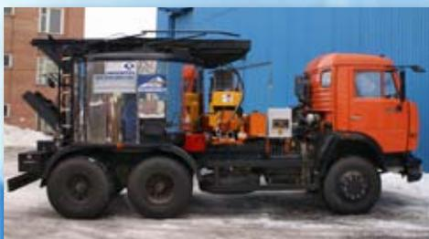
Машина МРД 5944 предназначена для ремонта дорог литым асфальтобетоном, удовлетворяет требованиям ГОСТ и ТУ РФ.
