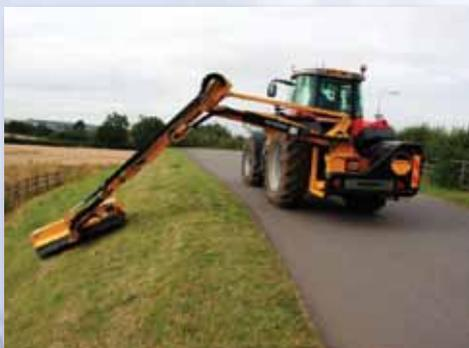
Производимое в России, совместно с компанией ЗАО «Коминвест-АКМТ», оборудование идеально для удаления нежелательной растительности с обочин и откосов дорожного полотна и обрезки деревьев.
