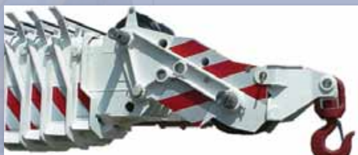
Фиксированный крюк на 22 тонны.
