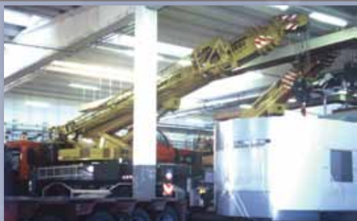
«Плавающая головка» на конце стрелы, для работы втесненных условиях.
