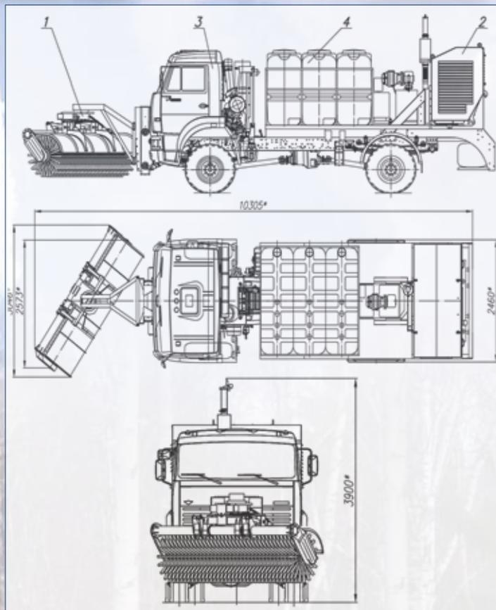
Высокоскоростная снежная щетка со смачиванием жидкими реагентами (до 50 км/ч)
