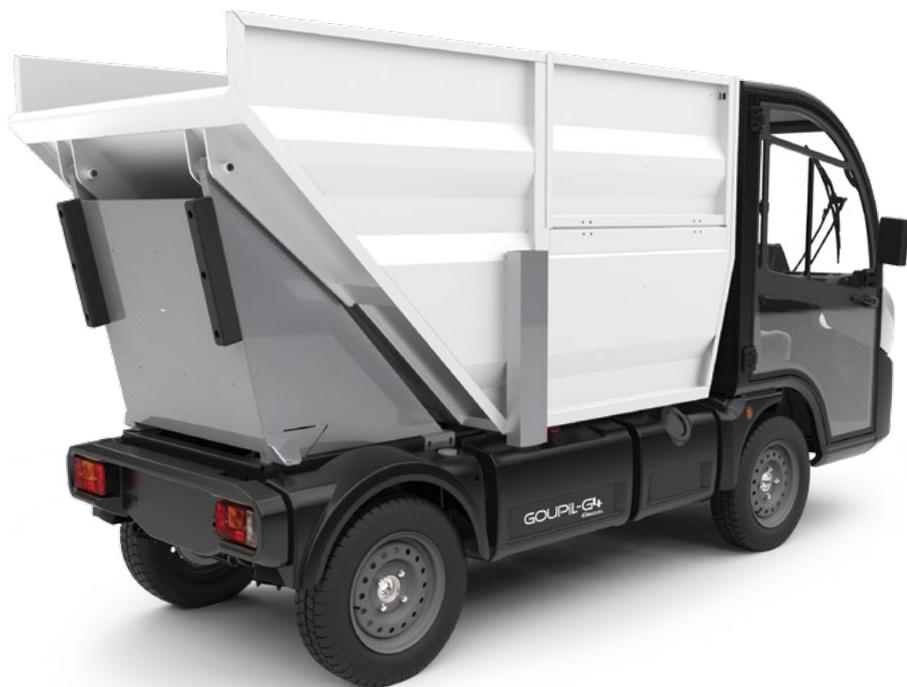
Разработанный для сбора корзин или небольших пакетов этот мусоровоз G4 с откидывающимся кузовом оснащен алюминиевым контейнером с грузоподъемностью 500 кг.
