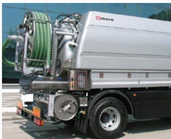
Задний барабан для всасывающего рукава. Длина рукава 40 м, диаметр 80.
