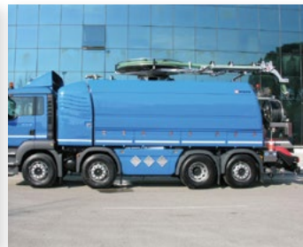
Верхняя гидрообъемная стрела с барабаном для всасывающего рукава, диаметр 80, 100, 150 мм.
