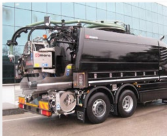
Верхняя стрела с барабаном для всасывающего рукава, диаметр 80 мм.
