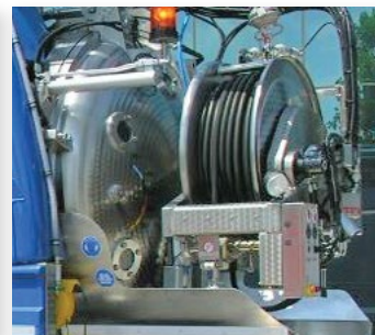
Большой барабан для 1", 1 1/4" рукавов ВД. Длина рукавов 100, 120, 180м.
