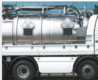
Верхняя стрела для всасывающего рукава. Гидрообъемный привод, диаметр рукава 4,5,6".
