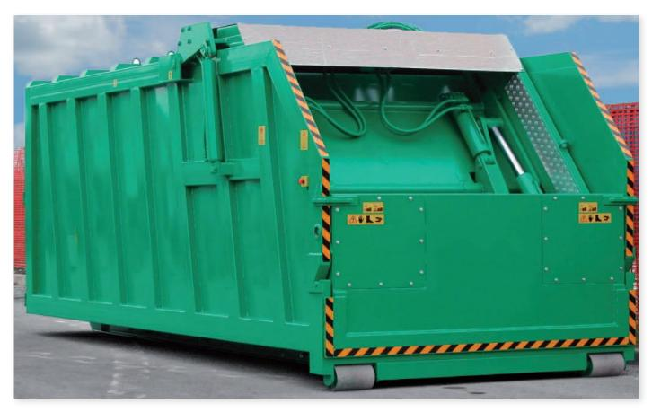
Мобильный компактор двухлопастный идеально подходит для загрузки отходов непосредственно с мусоровоза. Внутри емкости компактора установлена контр-лопасть которая позволяет увеличить коэффициент уплотнения отходов и упрощает выгрузку отходов при опрокидывание компактора. Система уплотнения гарантирует быстрое и эффективное сокращение объема отходов и позволяет использовать весь полезный объем компактора, позитивно влияя на общую эффективность услуг по сбору отходов.
