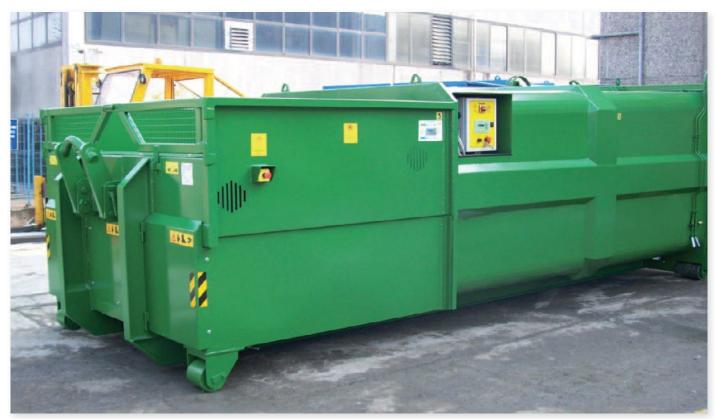
Мобильный компактор с пресс-плитой, широко распространенный благодаря высокой степени надежности, производительности и долговечности, выполняется с разными объемами загрузочного устройства, в зависимости от длины корпуса. Компакторы с пресс-плитой являются очень гибкими в использовании, не опасаясь никаких видов отходов. Наличие решеток перед загрузочной камерой делает его применение безопасным даже для городских жителей.
