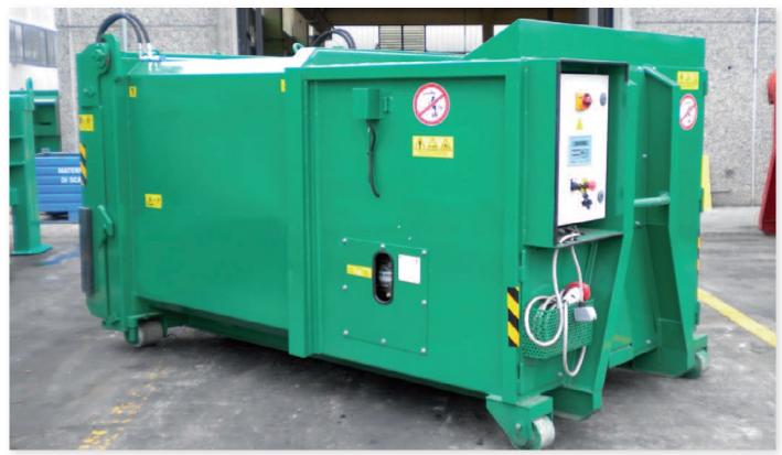
Данная типология компакторов, в связи с конструктивными характеристиками, рекомендована для установки там, где пространство очень ограничено. Электрогидравлическая система сравнима по производительности с компакторами больших размеров, но с наиболее высоким объемом единичной загрузки. Выполняемые с разными объемами загрузочного устройства, в зависимости от длины корпуса, эти компакторы способны обрабатывать любые виды отходов, обеспечивая эффективное и рациональное управление отходами.
