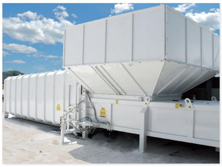
Стационарный компактор с пресс-плитой особенно подходит для применения на станциях сбора отходов, используя простую, но проверенную технологию уплотнения.
