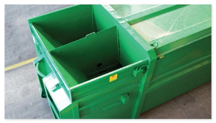
Компактор с пресс-плитой двухкамерный вмещает две разные фракции отходов, гарантируя их несоприкосновение.
