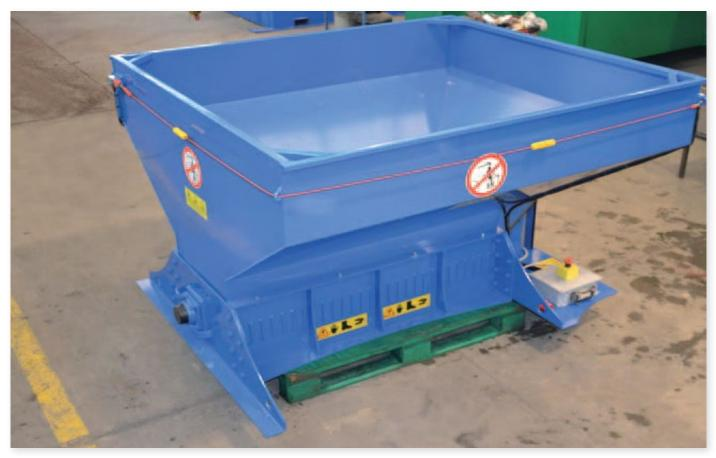
Измельчитель позволяет предварительно обрабатывать отходы, перфорируя и измельчая отходы перед уплотнением, с последующим повышением производительности пресса/компактора.
