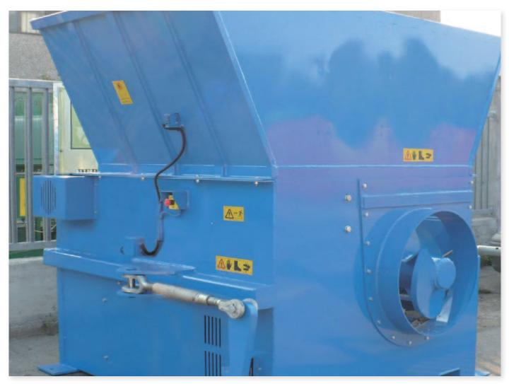
Стационарный компактор со шнековым прессом рекомендуется для уплотнения крупногабаритных материалов, картона, деревянных поддонов и других упаковочных материалов крупного объема.
