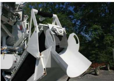
Короткая вставка под бетононасос
