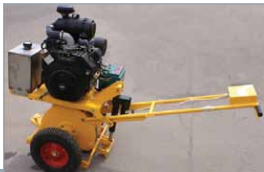
Машина по разделке трещин
