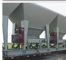
Смесительные башни Амоматик и горячие элеваторы спроектированы и испытаны в суровых условиях Скандинавского климата при работе с каменными материалами высокой твердости. Стандартные модули смесительных башен Амоматик имеют производительность до 300 тонн в час. Модули смесительных башен спроектированы для осуществления легкого и быстрого монтажа и демонтажа.
