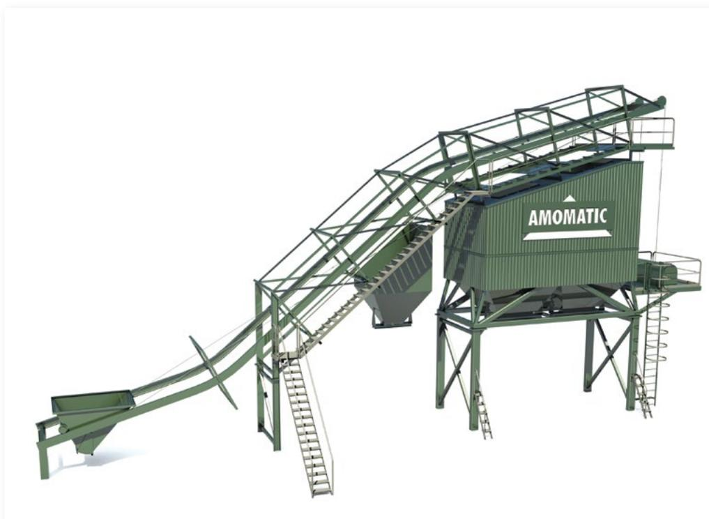
При проектировании бункеров-накопителей особое внимание было обращено на предотвращение расслоения асфальтовой смеси. Силосы или бункеры возможно оснастить различным оборудованием и аксессуарами. Для обеспечения высокой производительности и плавной работы АБЗ скорость скиповых тележек регулируется частотным инвертором. Разгрузочные люки бункеров снабжены системой электрообогрева в стандартном исполнении.
