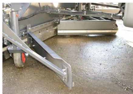
Оборудование для сбора антиобледенительной жидкости.
