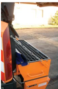
Заполнение песко-соляной смесью из бункера машины.
