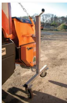
Монтаж оборудования на заднюю навеску машины.
