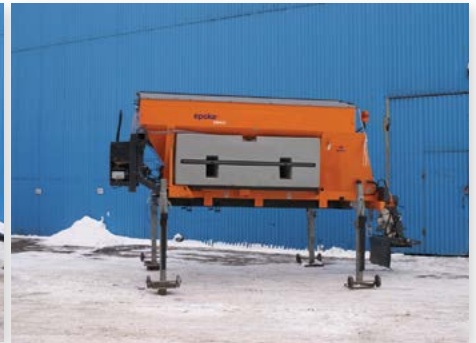
Подготовка оборудования к установке на шасси
