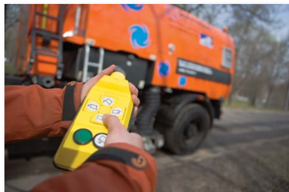
Выносной пульт на машине позволяет управлять опрокидыванием бункера и открыванием задней стенки вне кабины. При этом бункер может опрокидываться при работающем или при остановленном двигателе.
