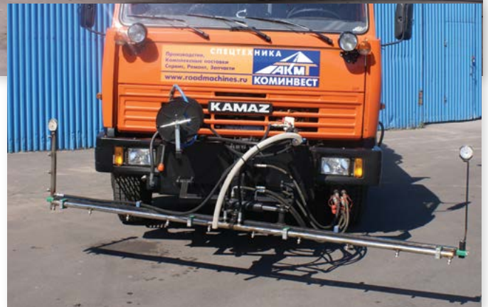
Система для работы в качестве поливмоечной машины.
