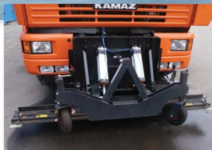
Магнитный брус для сбора металлических элементов.
