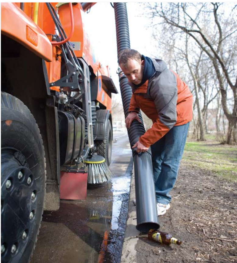
Всасывающий рукав, диаметром 150 или 200 мм может устанавливаться на поворотном круге сверху бункера и вращаться на 280 градусов, что обеспечивает возможность убирать мусор вокруг припаркованных автомобилей, за заборами - в радиусе 3500 мм, а также в ливневых колодцах глубиной до 2 метров.
