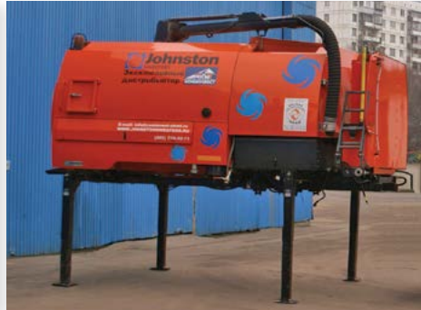
Подготовка оборудования к установке на шасси
